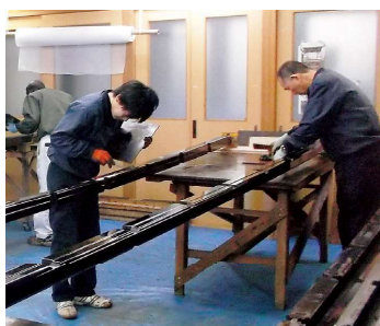
▲塗装してある箇所を埋める「錆付け」作業の様子
