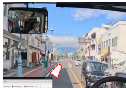
▲導流帯(ゼブラゾーン)の周辺に路上駐車回避できなかった際のシステムの検知状況
