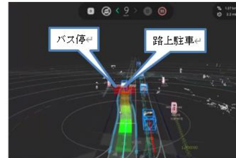
▲バス停周辺でのシステム検知状況 路上駐車や周辺歩行者を検知してバス停に正着できず、バス停の目の前に路上駐車車両に対して回避することも困難である。
