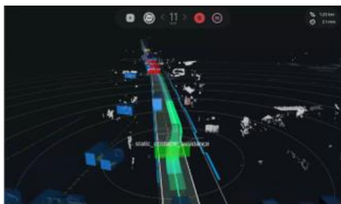
▲路上駐車回避が成功した場合のシステム検知状況
