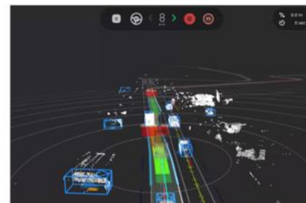
▲導流帯(ゼブラゾーン)の周辺に路上駐車回避できなかった際のシステムの検知状況
