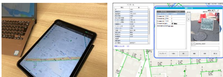
図 6.11 下水道台帳管理システムの画面例(左:携帯端末、右:維持管理情報の表示)
