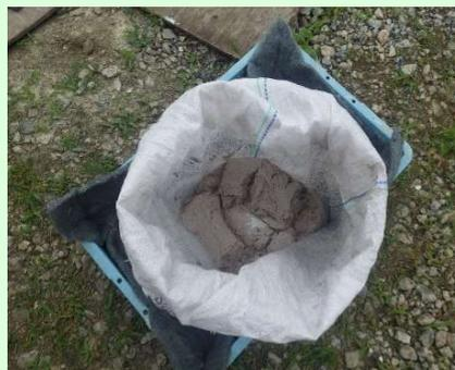
凝集分離ろ過装置を導入し、業務において排出される水溶性廃液を凝集・分離し、固形産業廃棄物と水に変換し処理できるようにしました。廃液処理剤を投与することで、廃液と凝集剤を混合・攪拌し、処理対象の汚濁廃水等が有機系、無機系を問わず、当該廃水に溶存している物質を沈殿、分解して浄化することができます。分離された処理水は廃液量の95%以上を放流可能な水質に改善され、残った固形物は可燃系廃棄物として排出できるようになりました。
