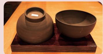
下地付けされたお椀は、ざらっとした土の手触りがします。中塗りの前に表面を砥石で水研ぎし、滑らかにします。
