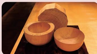
乾燥した木材を加工し、漆器の形を作ります。漆器によって、加工に使われる木材や使う道具が異なります。
