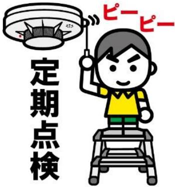
1か月に1回程度、住宅用火災警報器のボタンを押す、ひもを引くなどして点検してください。
