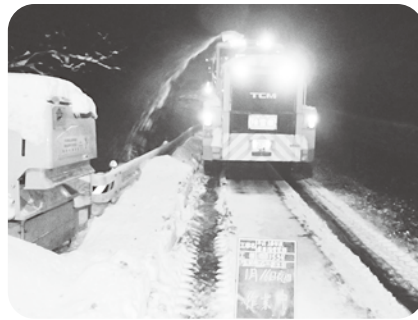
作業中のロータリー除雪車
