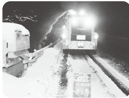
作業中のロータリー除雪車
