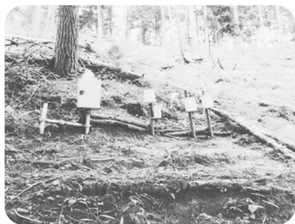
土中水分センサー 観測点6ヵ所で観測中
