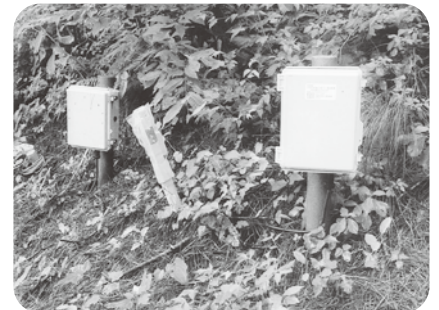
産・学・官で行われている、山林傾斜部の深さ毎の水分調査・データ送信機器
