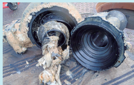
下水道ポンプの故障により、ポンプを分解した時の写真
