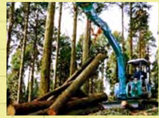
【スイングヤーダ】 建設用機械に集材用ウインチを搭載し、旋回可能なブームを装備する集材機
