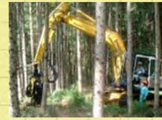
【ハーベスタ】 伐採、枝払い、玉切りの各作業と丸太の集積作業を一貫して行う自走式機械
