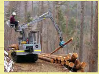
【フォワーダ】 玉切りした材をつかみ荷台上に積載して運ぶ集材専用トラクタ
