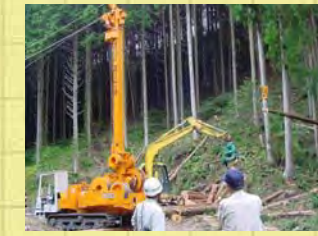
【タワーヤーダ】 架線集材に必要な元柱の代わりとなる人工支柱を装備した移動可能な集材車
