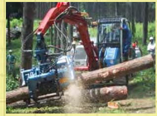
【プロセッサ】 伐採木の枝払い、玉切り（一定の長さに切り揃える）、丸太の集材作業を一貫して行う自走式機械
